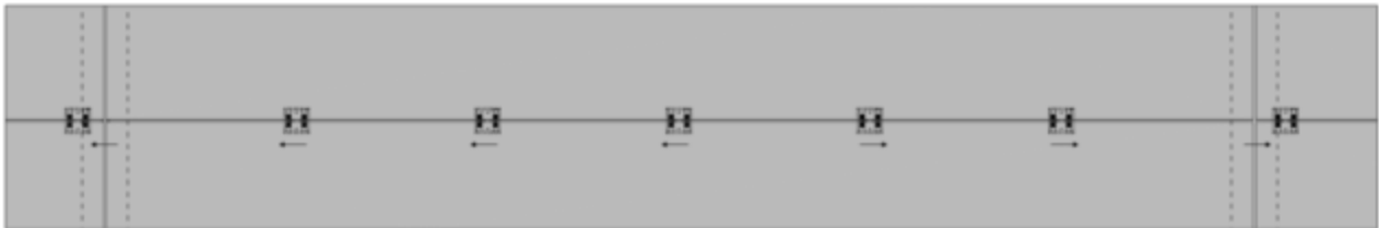
Figure 44 - Détail du déplacement des pattes-agrafes
